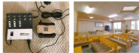
通所者の家庭に設置している、携帯電話を使った聴覚障害者用の緊急通報システム
