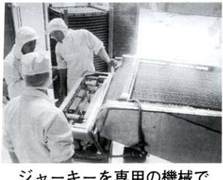
ジャーキーを専用の機械でカットします
